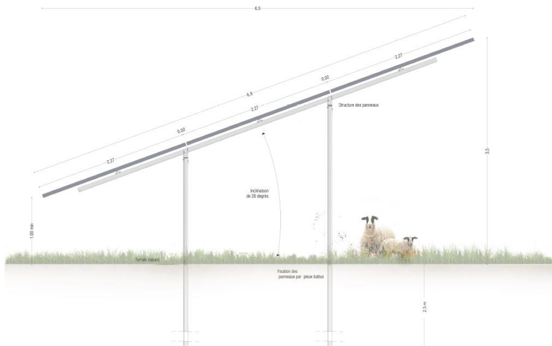
Figure 18. Coupe latérale d'une rangée de panneaux (PHOTOSOL)
